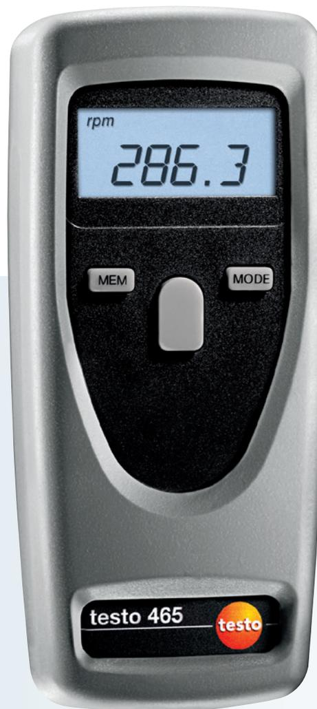
Le testo 465 permet de mesurer des régimes sans contact de façon très simple, avec une seule main. Il convient donc parfaitement pour les mesures sur les éléments en rotation, tels que des ventilateurs ou arbres. Il suffit de coller une marque réfléchissante sur l'objet à mesurer, d'orienter le faisceau lumineux rouge sur la marque réfléchissante et de mesurer. La distance par rapport à l'objet à mesurer peut ici s'élever à max. 600 mm.
