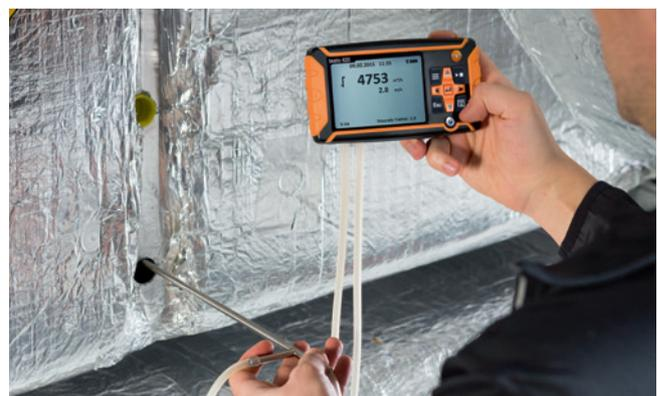
Instrumento de medición extraíble para poder realizar mediciones con tubo de Pitot en el canal (tubo de Pitot se puede adquirir por separado)
