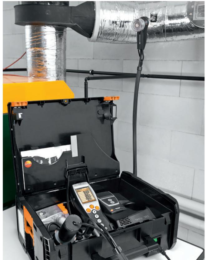
Schnelle und einfache Staubmessung mit testo 380.
