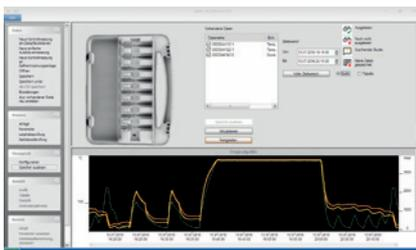
**Con el intuitivo software testo 190 CFR** se programan y leen los registradores de datos. Para el análisis de datos no se requiere una exportación (p. ej. a Excel). Gracias al informe con 1 clic es posible generar una documentación completa y relevante para las auditorías con solo un clic del ratón. Obviamente conforme a 21 CFR parte 11. En total se pueden leer hasta 254 registradores en un proceso de validación.
