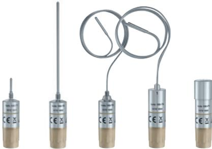
**Les enregistreurs de données CFR** sont disponibles en quatre versions pour la température plus une pour la pression. Ils sont synonymes de robustesse, de longévité et de fiabilité. Le changement de pile s'effectue de manière sûre et sans outil en quelques secondes grâce au pas de vis. Grâce à la conception hermétique de l'enregistreur, ce dernier reste entièrement étanche même après le changement de pile.
