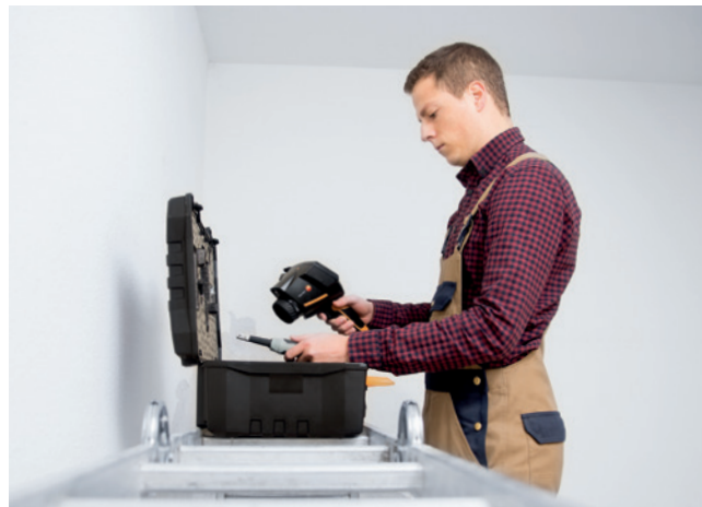
Im Set erhältlich: Wärmebildkamera mit Zubehör, Feuchtefühler und Koffer.
