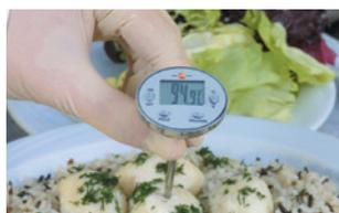
Para mediciones de temperatura por muestreo en la producción de alimentos.
