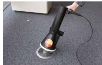
Le redresseur de flux testovent 417 permet désormais des mesures encore plus précises sur les bouches de soufflage.
