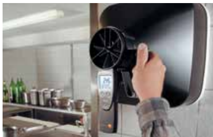
Contrôle en extraction au moyen d'un testo 417 et d'un cône de 330 x 330 mm.
