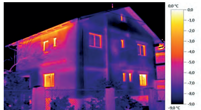
Puentes térmicos horizontales y verticales de un edificio.
