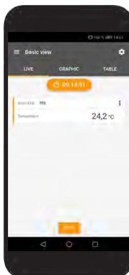
Con la App testo Smart gratuita, su smartphone se convierte en la pantalla del testo 915i. Tanto el manejo del Smart Probe como también la visualización de los valores medidos se llevan a cabo de forma inalámbrica por Bluetooth® en su smartphone, independientemente del lugar de medición. Además puede crear informes de medición en la App, añadirles fotos y comentarios y enviarlos cómodamente por correo electrónico.
