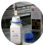
Para mantener la exactitud del medidor de aceite, o si los valores medidos presentan una desviación anormal, recomendamos calibrar y ajustar el instrumento con el aceite de referencia testo.
