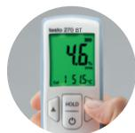
• Los valores límite de TPM se pueden ajustar en la App **testo Smart** de forma individual para las freidoras utilizadas.
