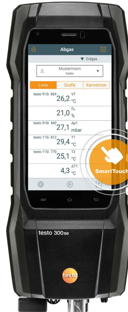
Abgasmessung nach 1. BImSchV und 44. BImSchV (mit NO-Sensor)
