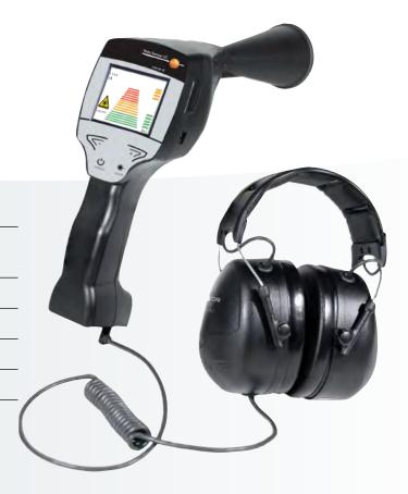
Beim Ausströmen von Gasen aus Leckagen in Rohrleitungssystemen (z.B. Korrosionen, undichte Schraubverbindungen usw.) entstehen Geräusche im Ultraschallbereich. Mit dem testo Sensor LD lassen sich auch kleinste Leckagen, die für das menschliche Ohr nicht hörbar und aufgrund ihrer Größe nicht sichtbar sind, bereits aus mehreren Metern Entfernung orten. Das testo Sensor LD wandelt den nicht hörbaren Ultraschall in hörbare Frequenzen um. Mit dem bequem
