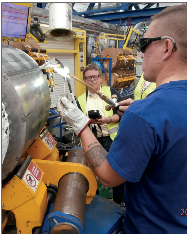
Měření produkce nanočástic v pracovním prostředí při manuální úpravě vodičů a kontrole zapojení vnitřní elektromotoru.
