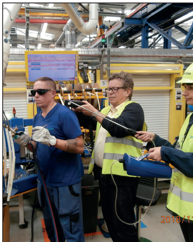
Měření produkce nanočástic v pracovním prostředí při sváření vodičů elektromotoru v úrovni vstupu do dýchacích cest .
