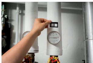
粘贴德图发射率标签
