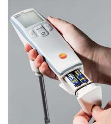
1. 请**小心**松开电池舱盖上的螺丝，打开电池舱。
