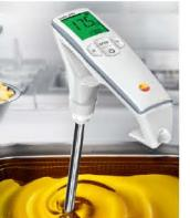
营运时段测量前将炸物取出，关闭炸炉，等待约5分钟，待油槽内无气泡冒出开始测量
