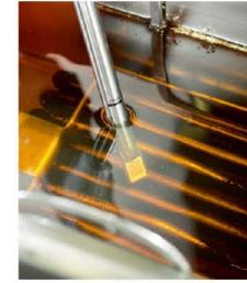
1. **每周**用新油对测油仪的准确性进行一次自校准
