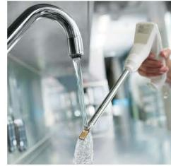
每日测量后和装箱前，在后区使用流动的**热清水**清洗探头并用餐巾纸吸干
