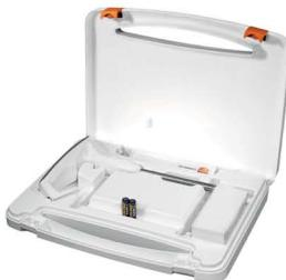
将检测仪器清洗后，先将探头放入仪器箱内标示位置，再将手柄放入箱内，然后将仪器箱扣好后放在指定存放位置。请勿将探头放在盒沿上，避免盒盖碰撞意外损伤
