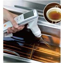
1. 将炸物取出，关闭炸炉，**撇去油渣**，等待约5分钟，待油槽内无气泡冒出开始测量
