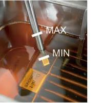
3. 将探头垂直浸入至油槽中心位置的热油中，轻轻搅拌，浸入深度在**MIN**/**MAX**标志间
