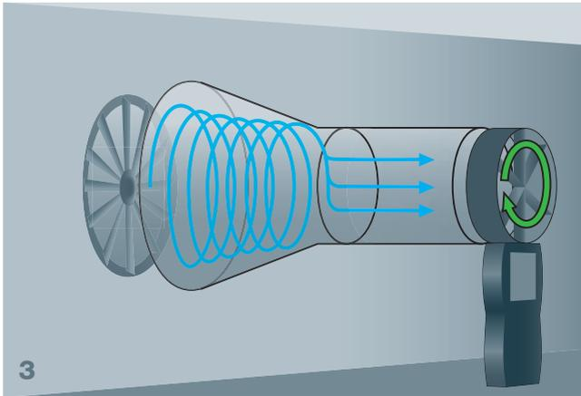
Der Volumenstrom-Gleichrichter testovent 417 beruhigt den Drall und sorgt so für präzisere Messergebnisse.
