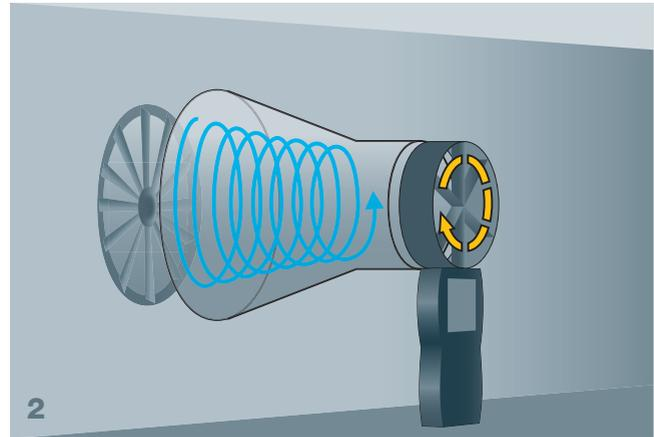
Rotationsrichtung des Dralls entgegengesetzt zu der des Flügelrades – es wird eine zu niedrige Luftströmung gemessen.
