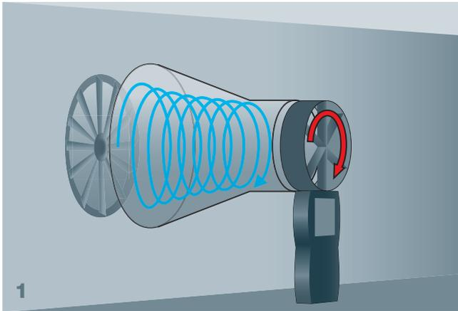
Rotationsrichtung des Dralls identisch mit der des Flügelrades – es wird eine zu hohe Luftströmung gemessen.
