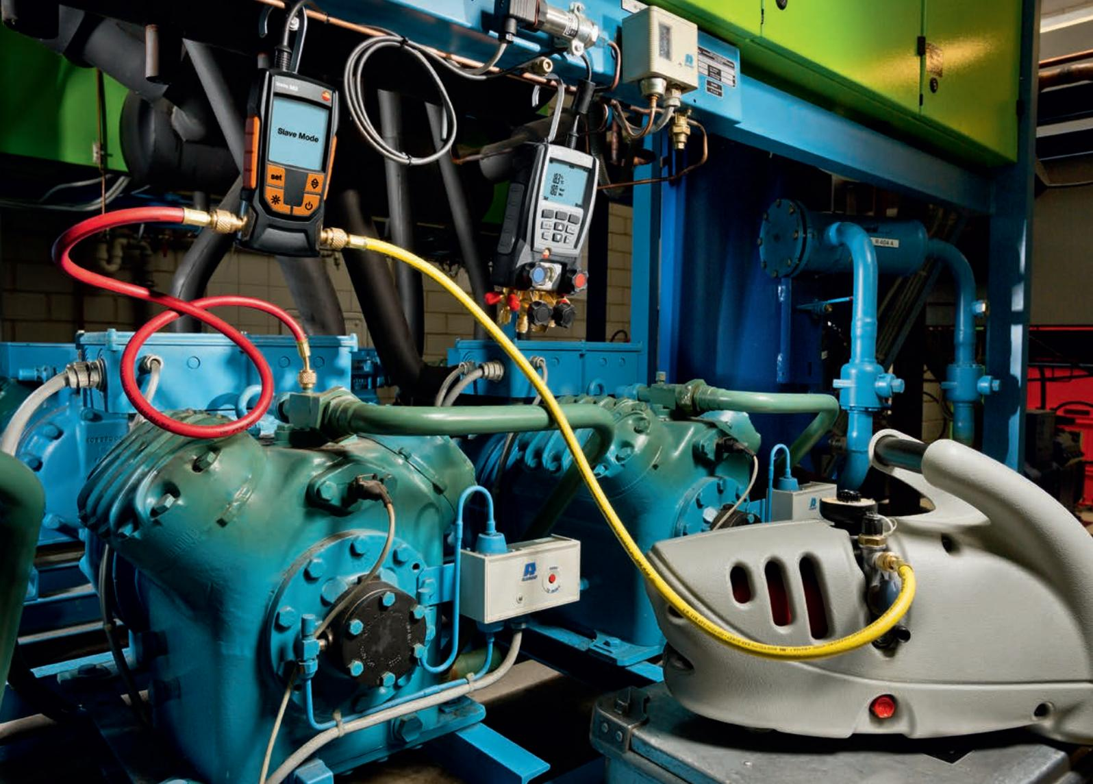
Pour enregistrer, imprimer ou documenter les données de mesure au format électronique, le testo 552 peut être connecté à la testo 570 grâce à un câble de connexion. Ceci est également possible pendant plusieurs jours pour des mesures de longue durée.
