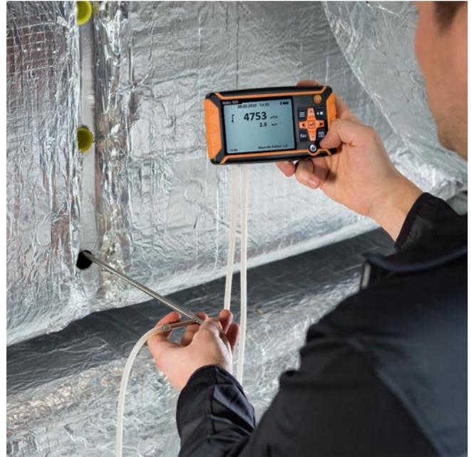
Appareil amovible permettant des mesures dans les canalisations au moyen d'un tube de Pitot (tube de Pitot disponible séparément)
