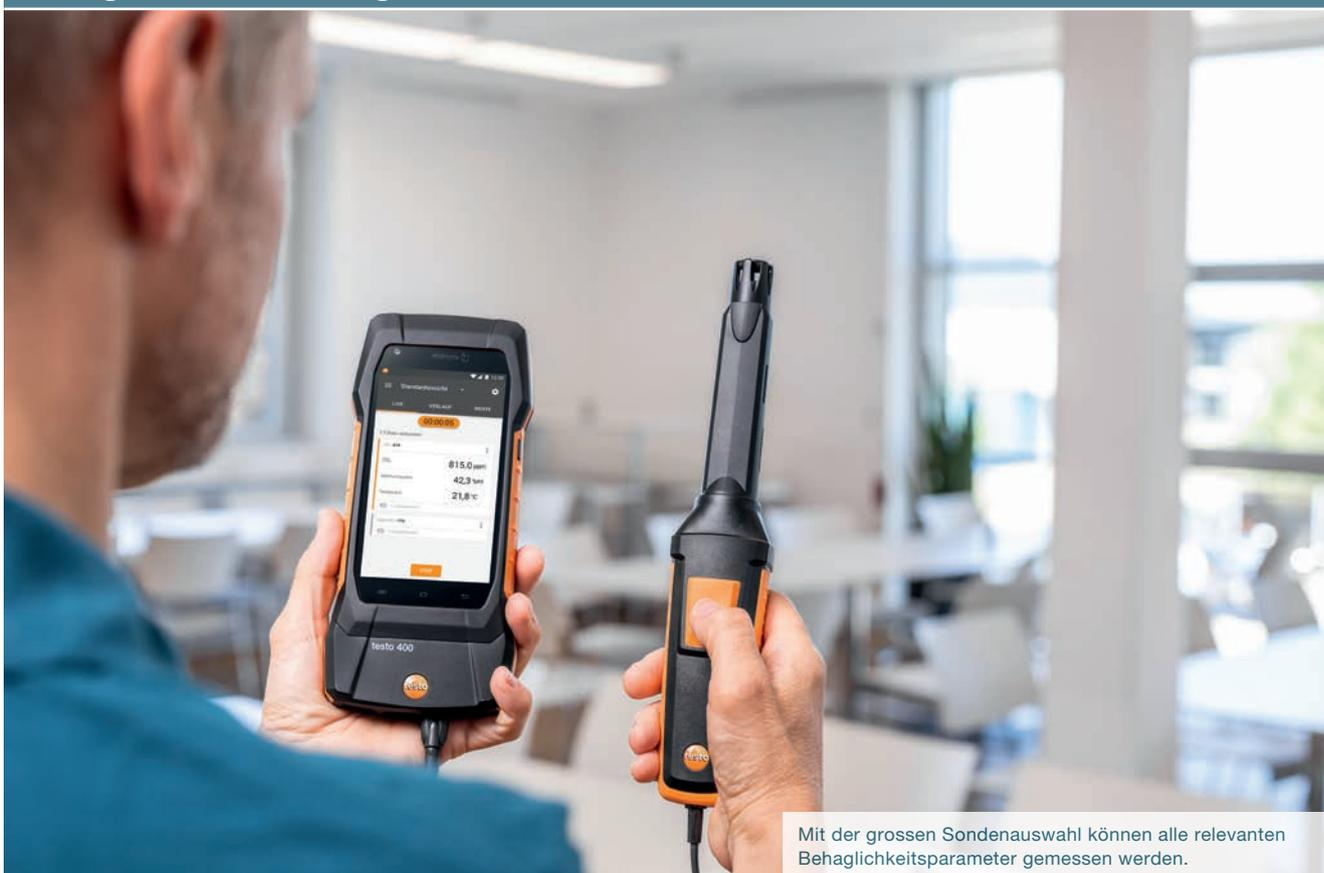
Mit der grossen Sondenauswahl können alle relevanten Behaglichkeitsparameter gemessen werden.
