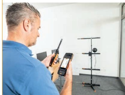
**Turbulenzgrad-Messung nach EN ISO 7730**
