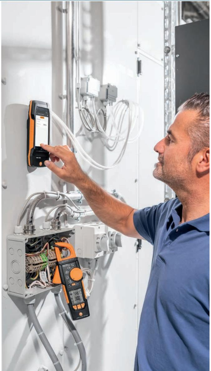
Mit testo 400 können Sie bis zu acht Sonden (4 x Bluetooth, 4 x Kabel) gleichzeitig verwenden.
