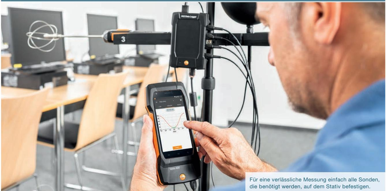
Für eine verlässliche Messung einfach alle Sonden, die benötigt werden, auf dem Stativ befestigen.
