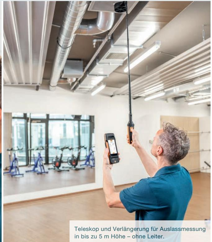
Teleskop und Verlängerung für Auslassmessung in bis zu 5 m Höhe – ohne Leiter.
