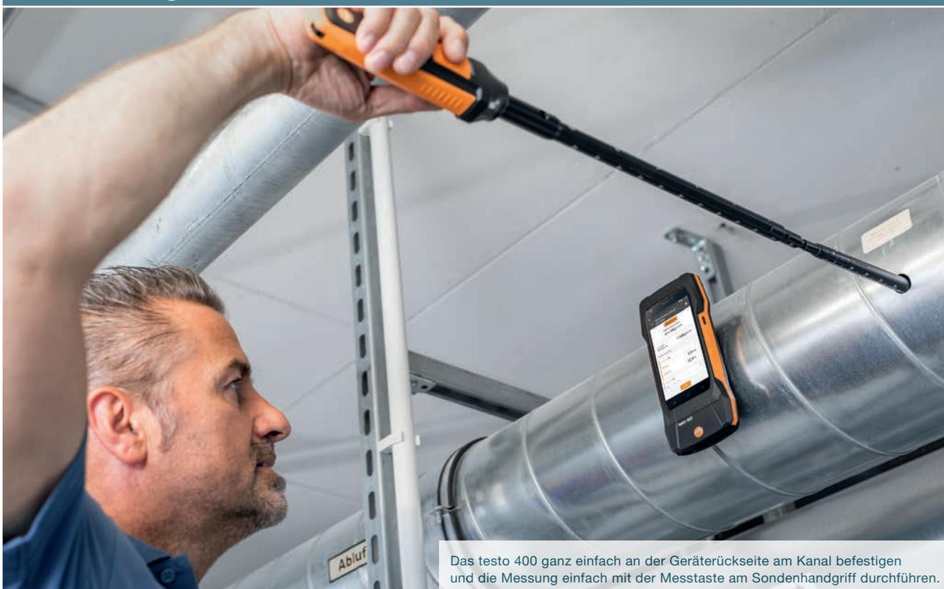
Das testo 400 ganz einfach an der Geräterückseite am Kanal befestigen und die Messung einfach mit der Messtaste am Sondenhandgriff durchführen.
