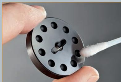
Ein einfaches Wattestäbchen und etwas destilliertes Wasser: Mehr brauchen Sie nicht zur Reinigung des Rotationsverdünners.
