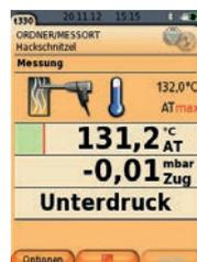
Die intuitive Menüführung sorgt dafür, dass keiner der gesetzlich vorgeschriebenen Schritte ausgelassen wird: Kernstromsuche und Zugmessung sind im Messablauf bereits integriert, auf wichtige Arbeitsschritte werden Sie stets hingewiesen. Für ein exaktes Messergebnis können Sie individuelle, von der Umgebung abhängige Parameter wie die Brennstoff- und Umgebungsfeuchte sowie -temperatur anpassen. Während der Messung können Sie die aktuellen Feinstaub- und Abgaswerte in Echtzeit verfolgen.
