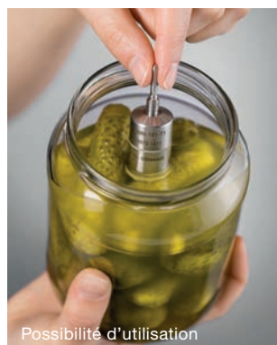
Mesure de température directement dans l'aliment : testo 191-T1
