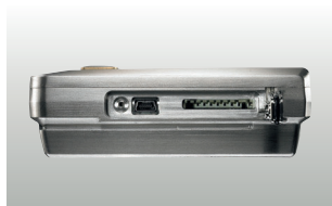
Conexão lateral para cabo Mini USB e cartão SD
