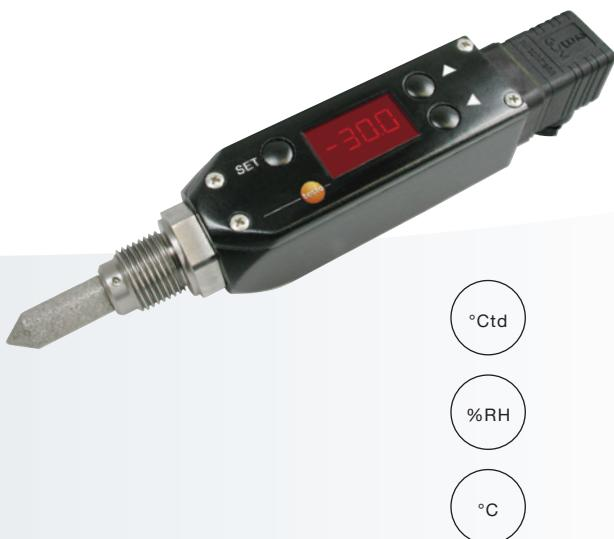
O testo 6740 foi especialmente desenvolvido para a medição de traços de umidade em ar comprimido ou seco (por exemplo, secadores de granulado). Graças a um ajuste especial, foi alcançada uma precisão ideal na faixa de traços de umidade.
