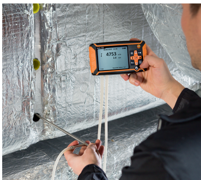
O instrumento removível permite medições de tubo de Pitot em dutos (tubo de Pitot disponível separadamente)
