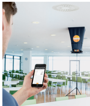
Integração do aplicativo via Bluetooth para visualização de dados de medição em dispositivos móveis e finalização do relatório de medição no local.
