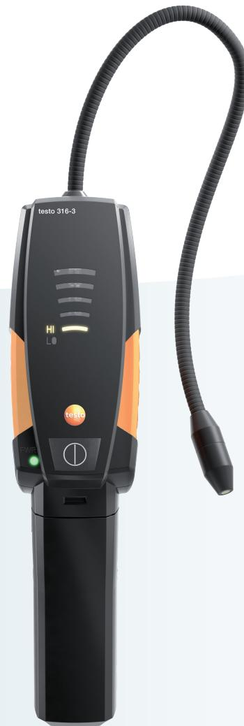
O testo 316-3 é um detector de vazamento confiável para refrigerantes que deve fazer parte do equipamento de tecnologia de refrigeração de todos os profissionais. Ele detecta até mesmo os menores vazamentos, graças ao seu alto nível de sensibilidade de 4 g/a, e atende aos requisitos do regulamento de gás F, bem como às normas SAE J1627 e EN14624:2012.
