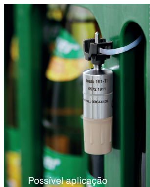
Medição de temperatura ambiente: testo 191-T1 + abraçadeira de retenção e abraçadeira (abraçadeira não incluída no escopo de fornecimento)
