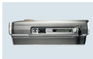
Conexão lateral de Mini USB cabo e cartão SD
