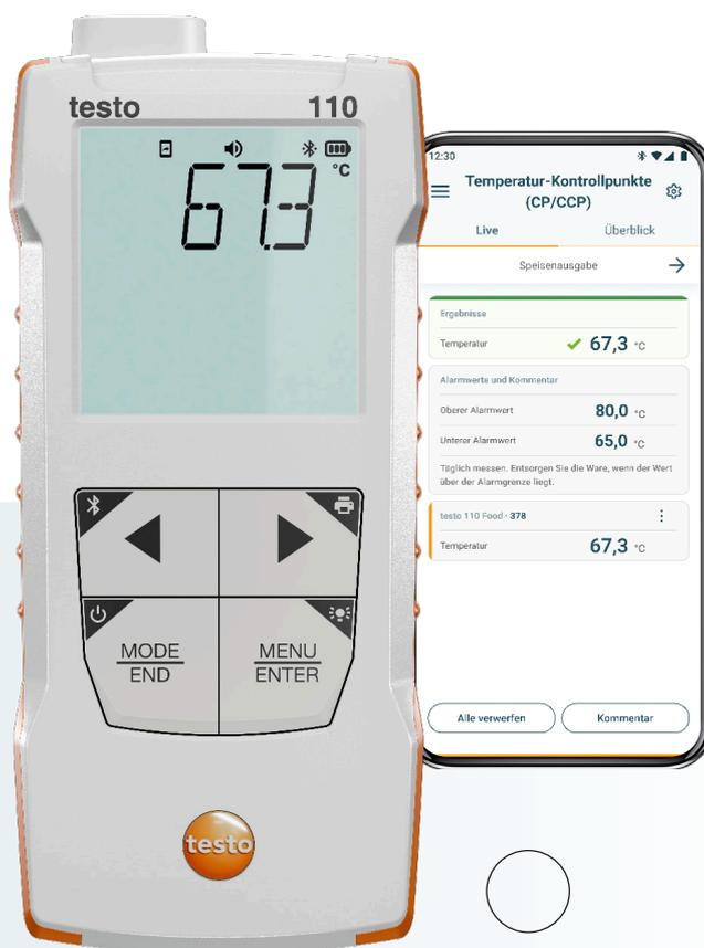
O compacto testo 110 Food é um instrumento de medição de temperatura altamente preciso e fácil de usar que pode ser usado universalmente para garantir a qualidade dos alimentos: Da produção ao armazenamento e transporte, passando pela preparação e venda. A conexão do aplicativo testo Smart torna a documentação digital e, sobretudo, o monitoramento do limite de temperatura (CP/CCP) mais fácil do que nunca.
