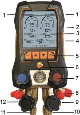
O diagrama mostra o teste 570s, um dispositivo eletrônico com uma tela colorida no topo que exibe vários dados de diagnóstico. Abaixo da tela, há um conjunto de botões de controle. O corpo do dispositivo é preto e amarelo, com dois grandes visores de fluxo de fluido refrigerante. Na base, há quatro conectores de mangueira: dois de alta pressão (NTP) e dois de baixa pressão (NTP). Linhas numeradas de 1 a 12 apontam para cada um desses componentes.
