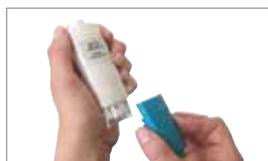
Echange simplifié de l'électrode sur les testo 206-pH1 / -pH2
