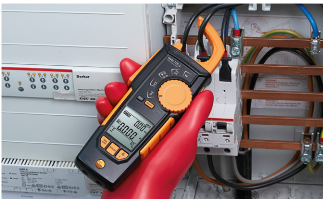
Contactloze metingen aan kabels die dicht op elkaar zitten gaan gemakkelijk en veilig met de stroomtang testo 770-3 : één bek kan helemaal worden ingetrokken.
