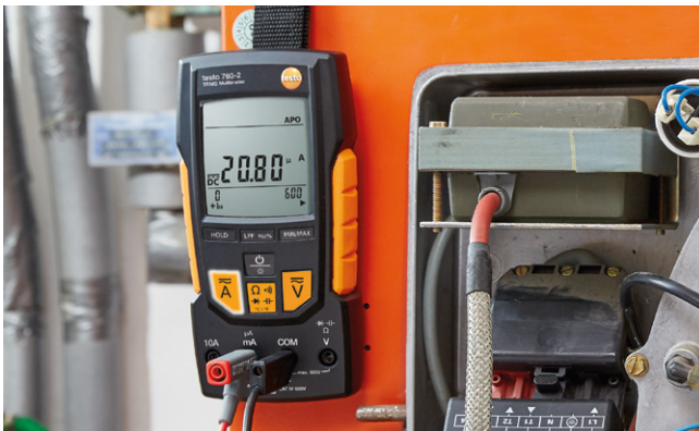
Dankzij automatische meetgrootte-herkenning biedt de digitale multimeter testo 760-2 maximale zekerheid bij elke toepassing.
