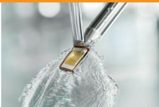
Gerät mit mildem Spül-/Reinigungsmittel reinigen. Sensor unter fließendem Wasser abspülen und mit einem weichen Papiertuch vorsichtig abtrocknen.
