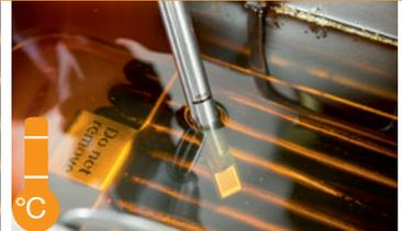
Messen Sie in heißem Öl min. 40 °C, max. 200 °C bei nicht kontinuierlichem Einsatz.
