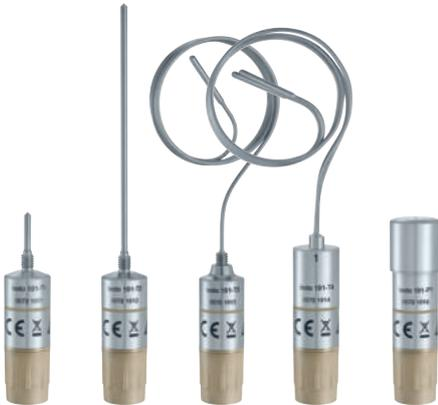
**Die HACCP Datenlogger** gibt es in vier Temperatur- und einer Druckausführung. Sie stehen für Robustheit, Langlebigkeit und Zuverlässigkeit. Der Batteriewechsel kann aufgrund des Drehgewindes sicher und ohne Werkzeug in wenigen Sekunden durchgeführt werden. Dank der hermetisch dichten Konstruktion des Loggers, bleibt der Logger auch nach dem Batteriewechsel zu 100 % dicht.
