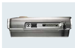
Seitlicher Anschluss von Mini-USB-Kabel und SD-Karte
